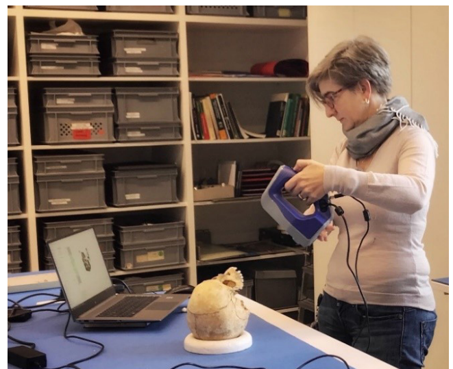
S. Braun beim Scannen eines Schädels mit dem Artec Space Spider.
