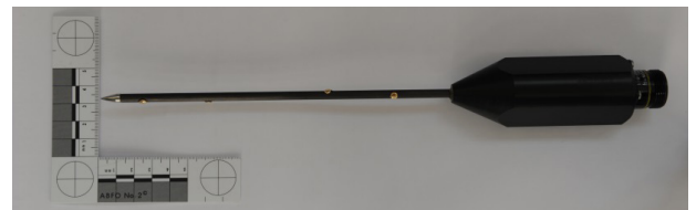
Neu entwickelter hochauflösender Temperaturmessfühler mit fünf unabhängigen Sensoren, der die Auskühlung in verschiedenen Körpertiefen dokumentiert.
