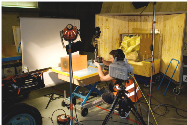
Wund- und zwischenballistische Untersuchung eines Vorderladers
