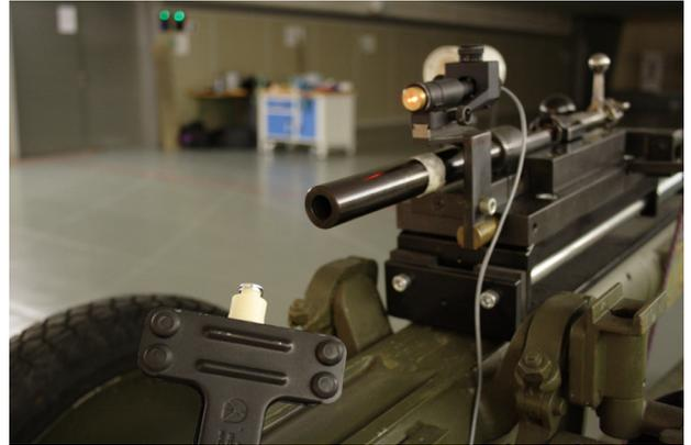
Schmauchaufnahme anlässlich eines Versuches mit Polizeimunition. Im Hintergrund: lafettierter 9 mm Luger Messlauf
