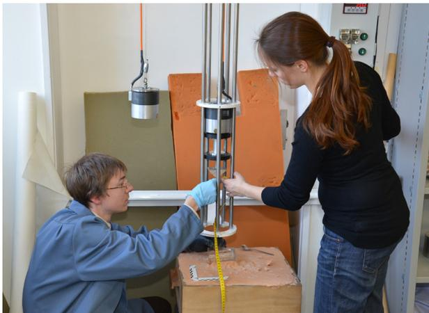
Ermittlung der notwendigen Energie zum Brechen eines Bierglases
