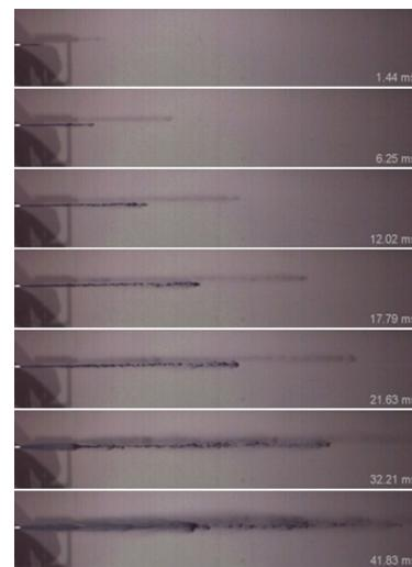
Messung der Energie eines Strahles. Ein Pfefferspray wird auf die Gefährlichkeit der mechanischen Einwirkung seines Strahles untersucht.
