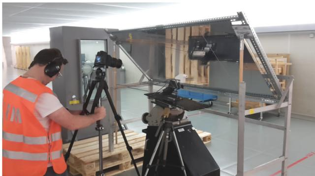
Vorbereitungen für eine Hochgeschwindigkeitsaufnahme der Schussauslösung einer 3D-gedruckten Liberator Pistole. Der Spiegel dient zur gleichzeitigen Aufnahme von oben.
